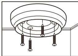
ツメと溝を合わせ、ドームカバーを回し、取り付けます。
