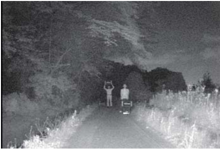
18 灯の大型 LED で投光距離約 15m の夜間撮影が可能（白黒映像）
