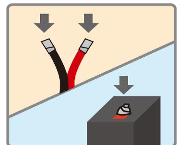
切断したコードの先端、電池をガムテープやビニールテープで絶縁処理します。
