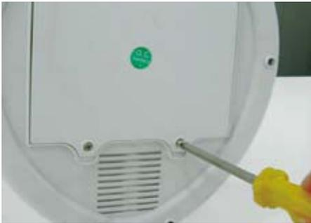
充電電池のカバーのネジをプラスドライバーで緩めカバーを外します。
